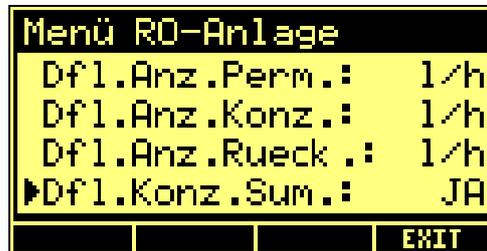
Für den Fall der Summenmessung wird der Anzeigewert Rückführmenge um den Messwert der Kanalmenge verringert. Während des Spülvorgangs werden in diesem Fall die Anzeigen für das Konzentrat ausgeblendet.
