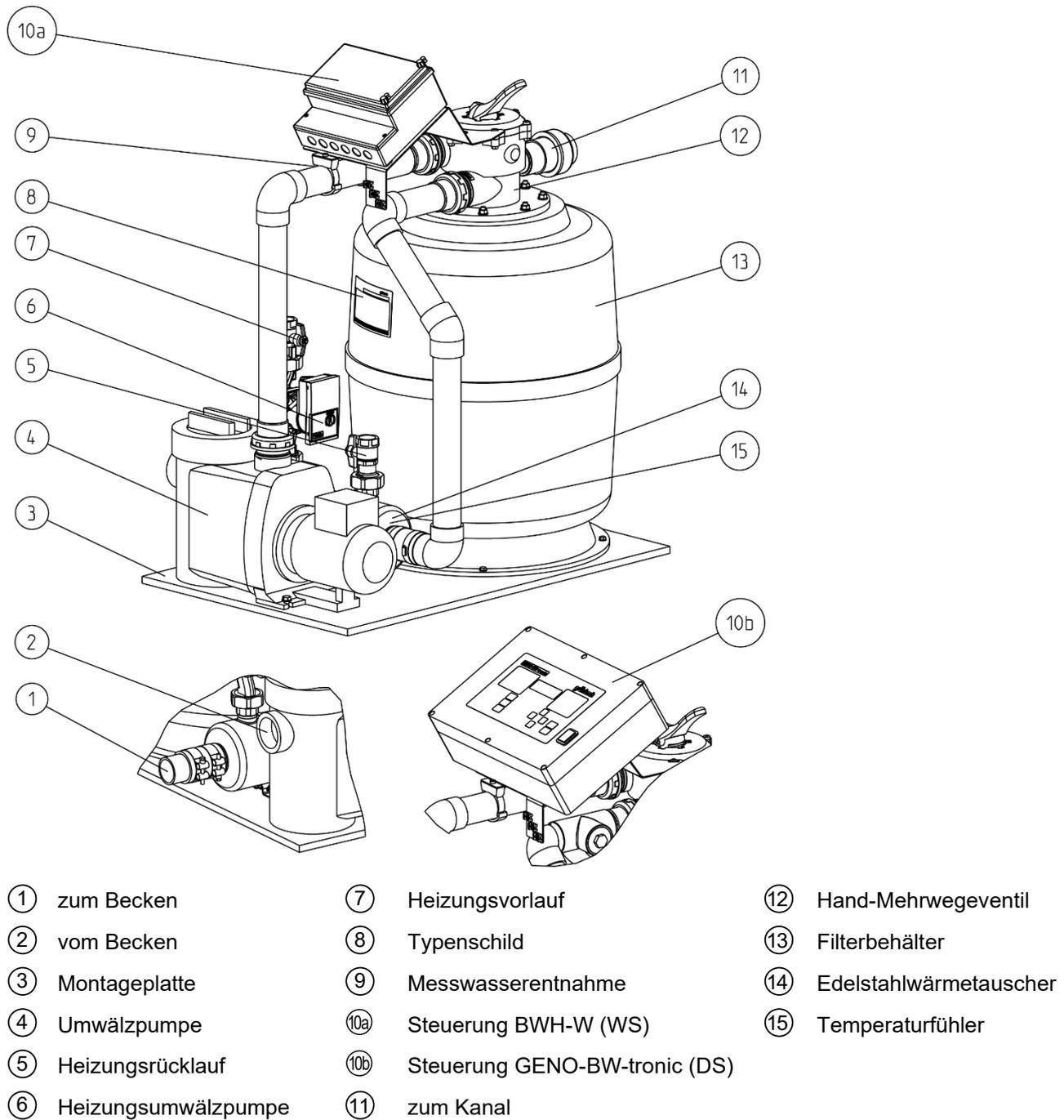
Abb. C-1: Komponenten Filteranlagen GENO-mat F 500 HK
