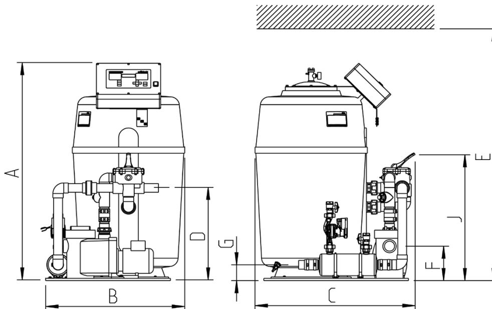
Abb. C-4: Maßzeichnung Filteranlage GENO-mat F 600 HK (DS)
