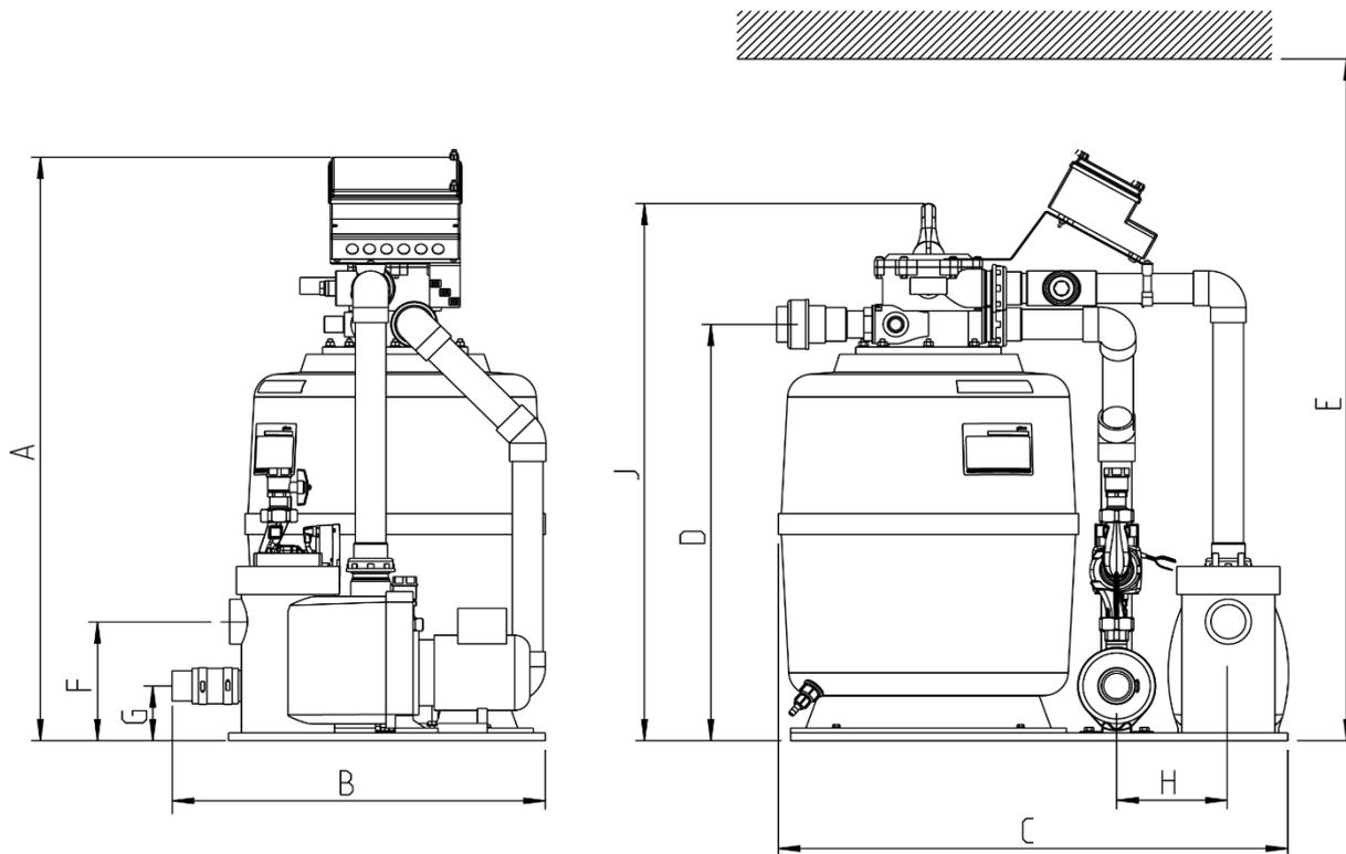
Abb. C-3: Maßzeichnung Filteranlage GENO-mat F 500 HK (WS)
