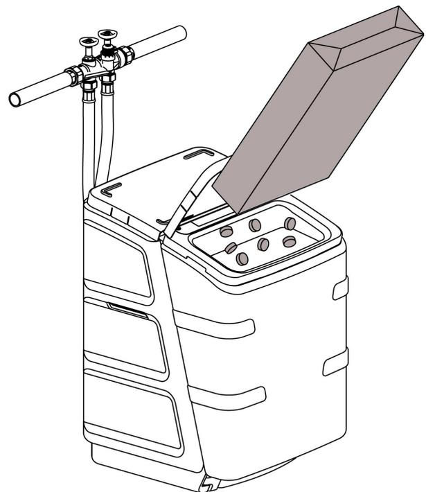
Ein oder zwei 25 kg-Säcke Salztabletten in Salztank einfüllen.
