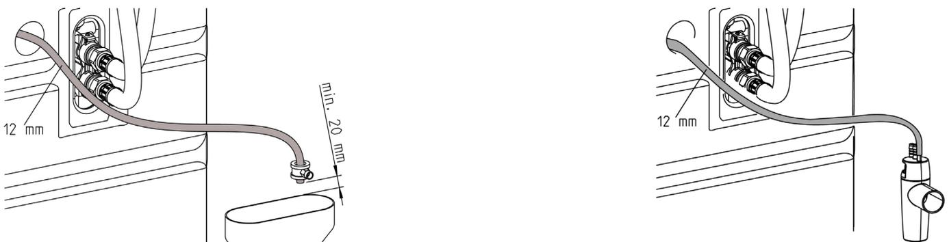
Abb. D-3: Kanalanschluss Spülwasserschlauch mit und ohne Kanalanschluss DN 50 nach DIN EN 1717 (Bestell-Nr. 188 875)
