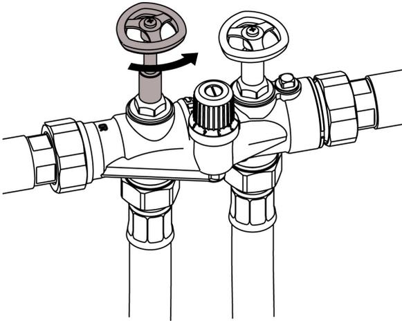
1. Absperrventil Rohwasser am Anschlussblock öffnen.
